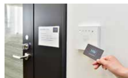
入退室時にかざすライセンスカードは、IC乗車券や社員証でもおなじみのFeliCaカードを選択。NewWorkでも、セキュリティ・勤怠管理・全国共通利用など重要な役割を担う。利用者には勤務先から1人1枚支給される。
